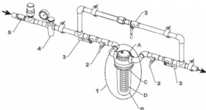
1. Filtro A) Testa B) Vaso C) Ghiera D) Cartuccia 2. Rubinetto test acqua 3. Rubinetto intercettazione 4. Riduttore di pressione 5. Valvola di ritegno
