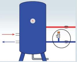
A protezione del vaso di espansione e dell'impianto è bene installare la valvola prima di quest'ultimo
